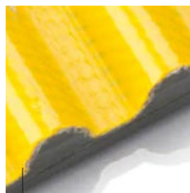
Mit Polyurethan getränktes Spezialgewebe Polyurethane- impregnated special fabric
