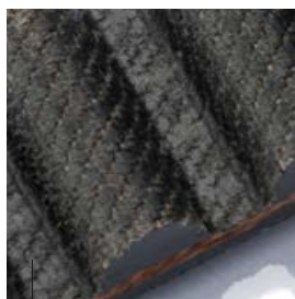
Einfaches Polyamidgewebe Simple polyamide fabric
