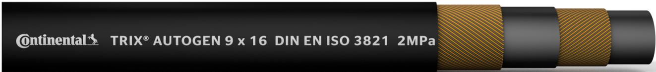
**KENNZEICHNUNG:** auf schwarzem Untergrund "Continental TRIX® AUTOGEN DN 9 x 16 DIN EN ISO 3821 2MPa (20 BAR / 290 PSI) Made in Germany"
